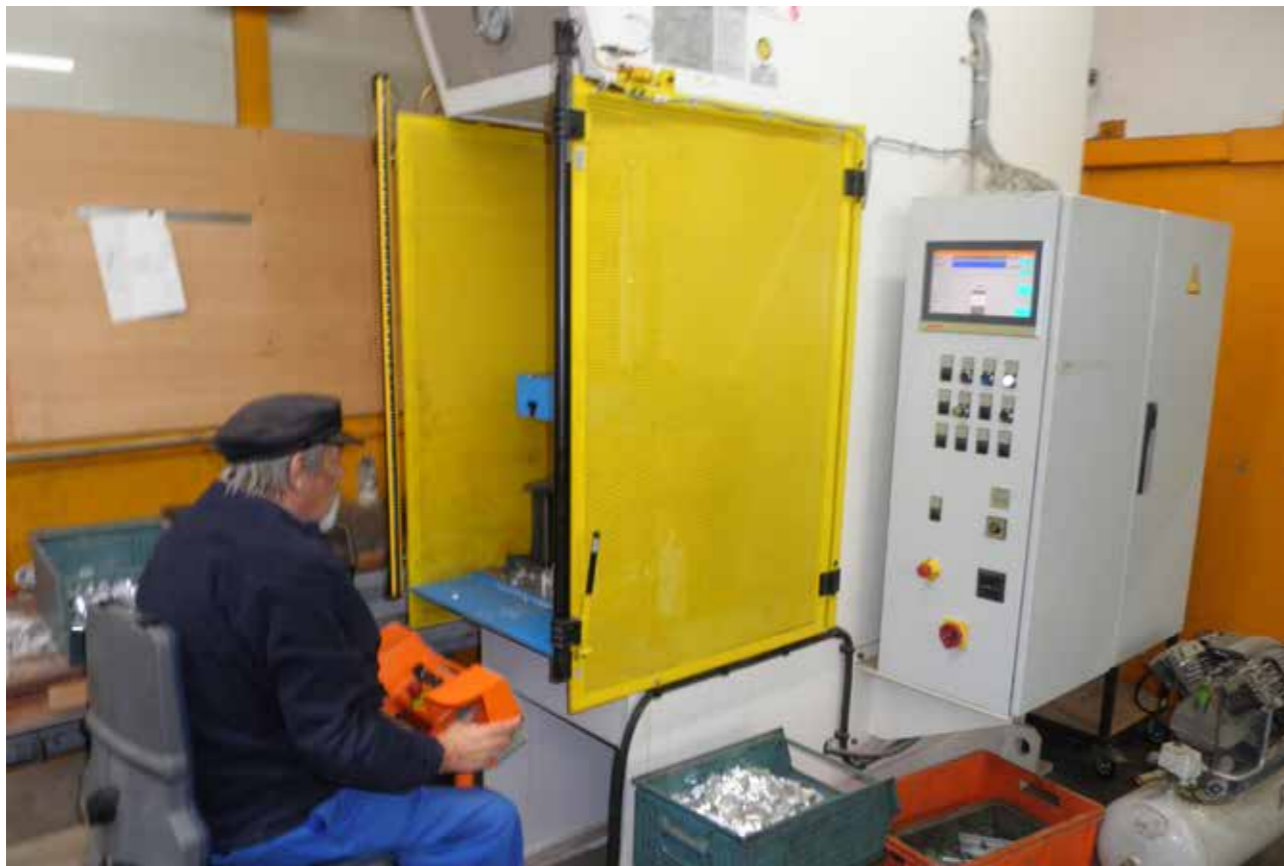
Die Zeulenroda 40 – Tonnen – Presse wird in den Handwerklichen Dienstleistungen Wilhelmsdorf zur Metallverarbeitung eingesetzt. Sie ist mit einem Lichtvorhang als Eingriffsschutz ausgestattet. Die Maschine bedient Meinert Hinrichs.
