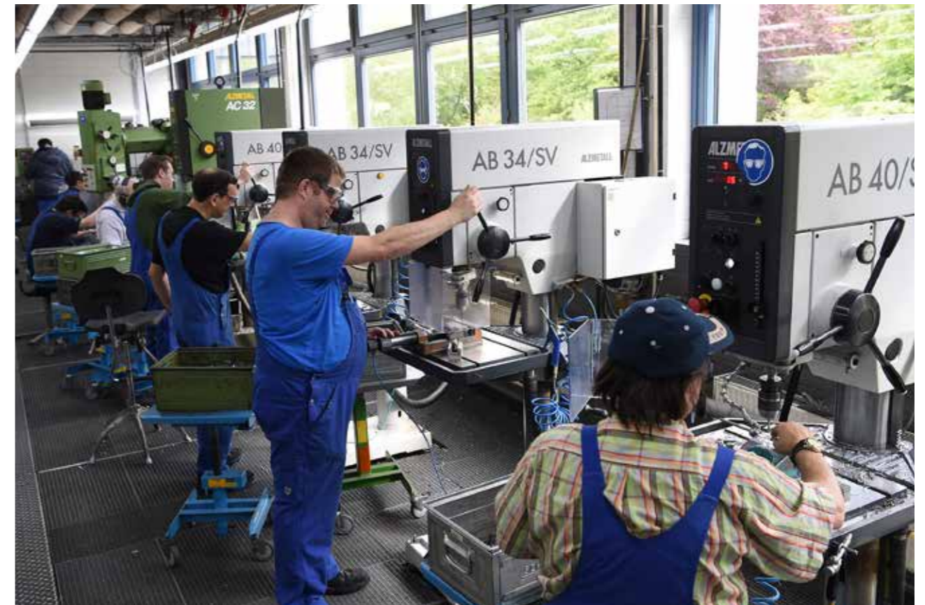
Standbohrmaschinen in der Bernhard-Mosberg-Werkstatt: Mit dem Bohrspindelschutz sind die Menschen in der unmittelbaren Umgebung vor fliegenden Metallteilen geschützt. Wird der Spindelschutz, zum Beispiel beim Werkzeugwechsel weggeklappt, kann die Maschine nicht gestartet werden.
